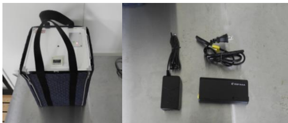
図 3-4-4 昭和フランキ社製 携帯用フ卵機SR-2 とバッテリー
